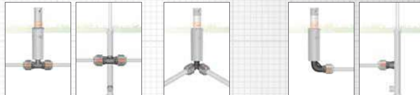
Met T-stuk 25 mm met 1/2" buitendraad Art. 2786 of 3/4" buitendraad Art. 2787 Aansluiting verzonken sproeier S 80/300: Met T-stuk 25 mm met 3/4" binnendraad Art. 2790 Met hoekstuk 25 mm met 1/2" buitendraad Art. 2782 met 3/4" buitendraad Art. 2783 Met L-Stuk 25 mm met 1/2" buitendraad Art. 2780 met 3/4" buitendraad Art. 2781 Aansluiting verzonken sproeier S 80/300: Met verbindingsstuk 25 mm met 3/4" binnendraad Art. 2761
